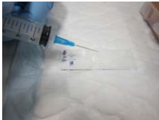
图7.3：准备玻璃片：除去针头，将注射器抽满空气，然后把里面的物质全部注射到一片玻璃片上
